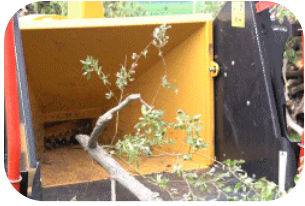
Barre de contrôle de sécurité
